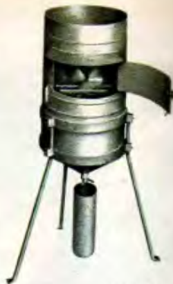
بارسنج (مقدار ریزش را تعیین می کند)
