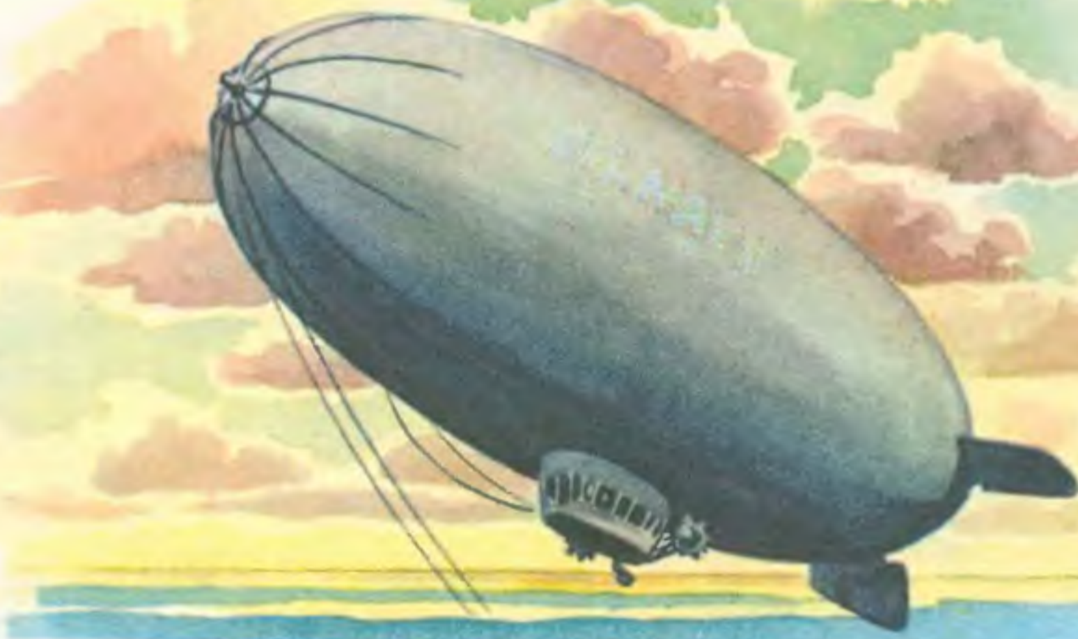
بالونهای پر از هلیوم نیروی دریایی برای جستجوی زیردریاییها به کار می‌روند.
