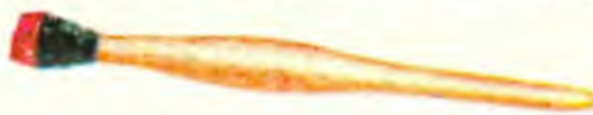
پایه برای نگاه داشتن جواهرات هنگام بریدن و صیقل دادن آنها
