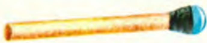
پایه برای نگاه داشتن جواهرات هنگام بریدن و صیقل دادن آنها
