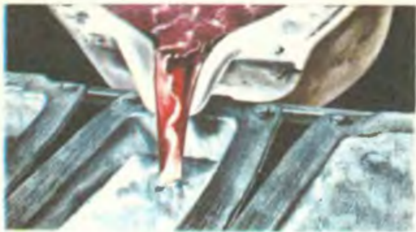
آلومینیوم مذاب به شکل آلومینیوم «خام» در می آید. پس از آنکه سرد شد به کارخانه‌ها فرستاده می‌شود.
